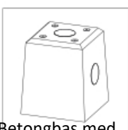
07. Betongbas med utsläpp av regnvatten
